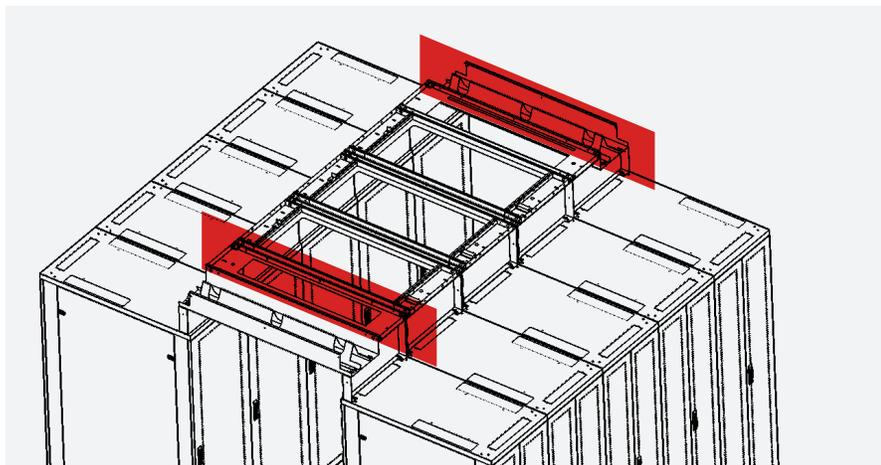
Para su instalación debe utilizar los tornillos M5 \* 10.
