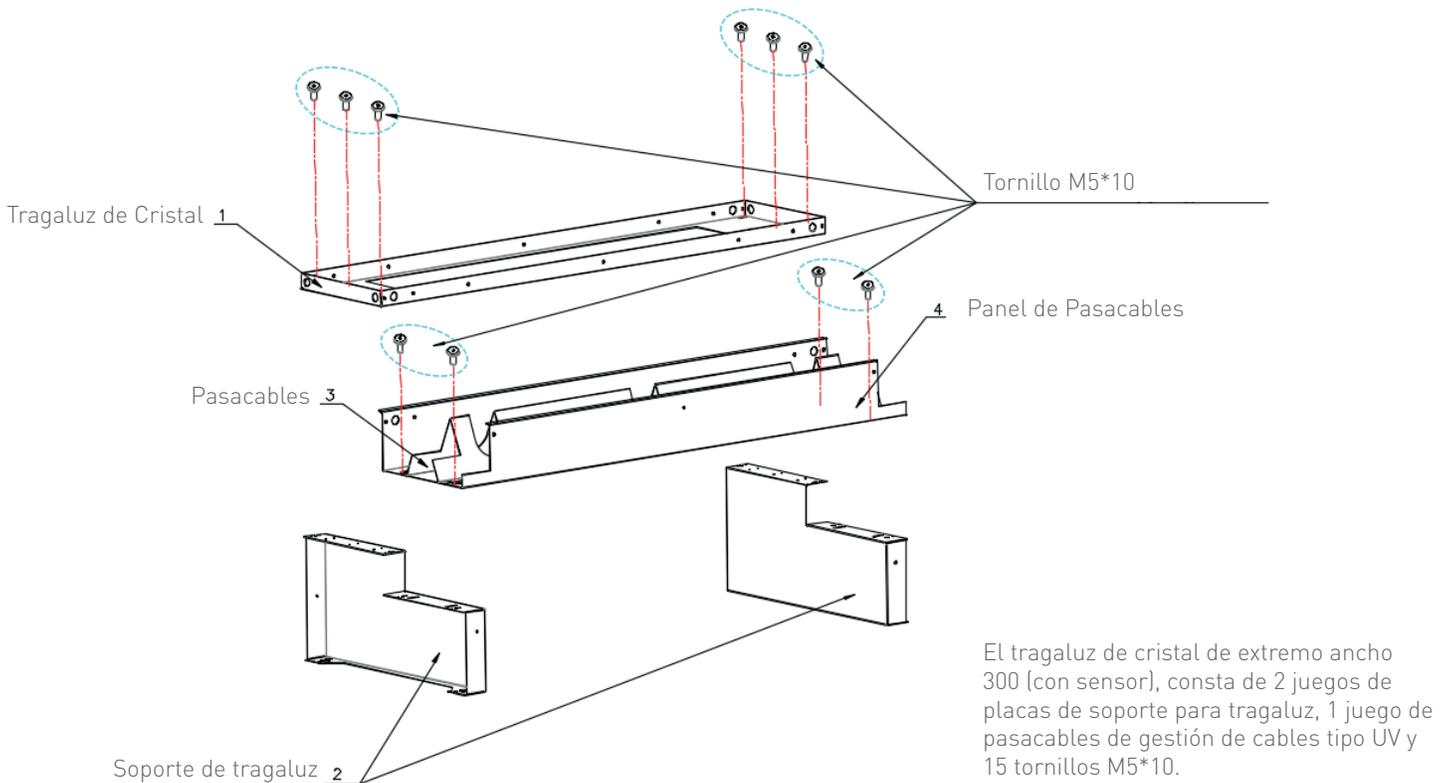
Al instalar el tragaluz, debe asegurarse que este orientado correctamente el pasa cables debe estar orientado a la parte exterior del Cold Center y el tragaluz de cristal debe orientarse al pasillo del Cold Center.
