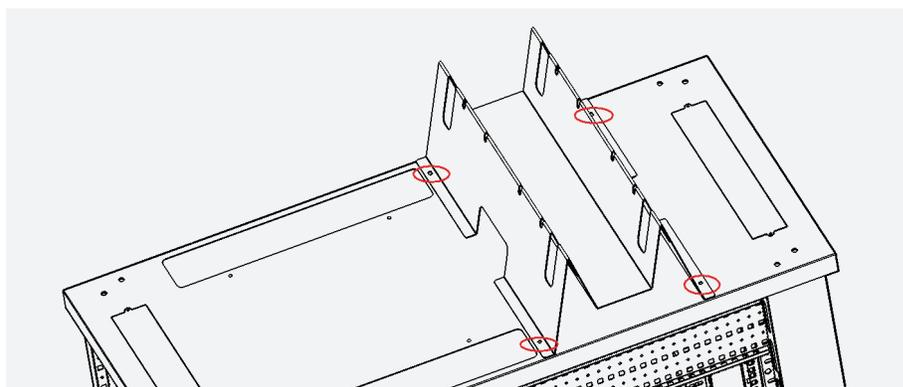
Instale el pasacables en la parte superior del gabinete con los tornillos M5.
