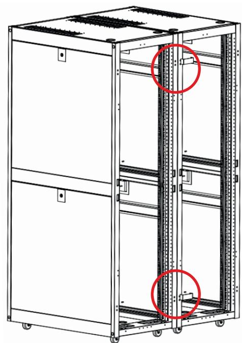
Una vez que se tienen ya instalados correctamente los gabinetes en fila se deben proceder a unirlos con los accesorios del Cold Center.
